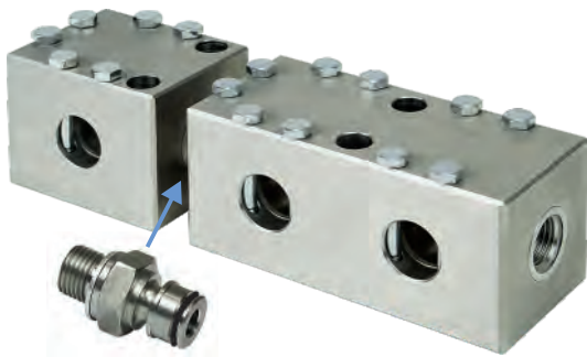
Beispiel Verteilerleistenkombination kpl. PN250 - DN8 - 7x DN2 Steck - G1/4i, bestehend aus Art.Nr. 2000032, 2000030, 0009878, 0005816
